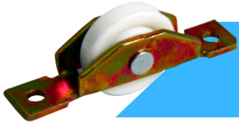
Rodamiento en Nylon 100%, para vitrinas y divisiones de baño, pasador en acero de 1/8 y carcasa en Cold Rolled calibre 16 irisado.
